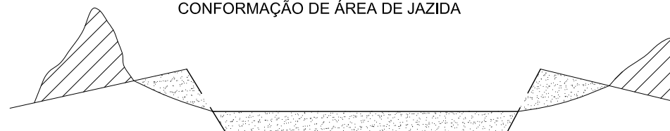
5 - CONFORMAÇÃO DE ÁREA DE EMPRÉSTIMO COM COBERTURA DE MATERIAL ORGÂNICO
