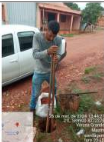
Coleta dos furos de sondagem - Furo 03
