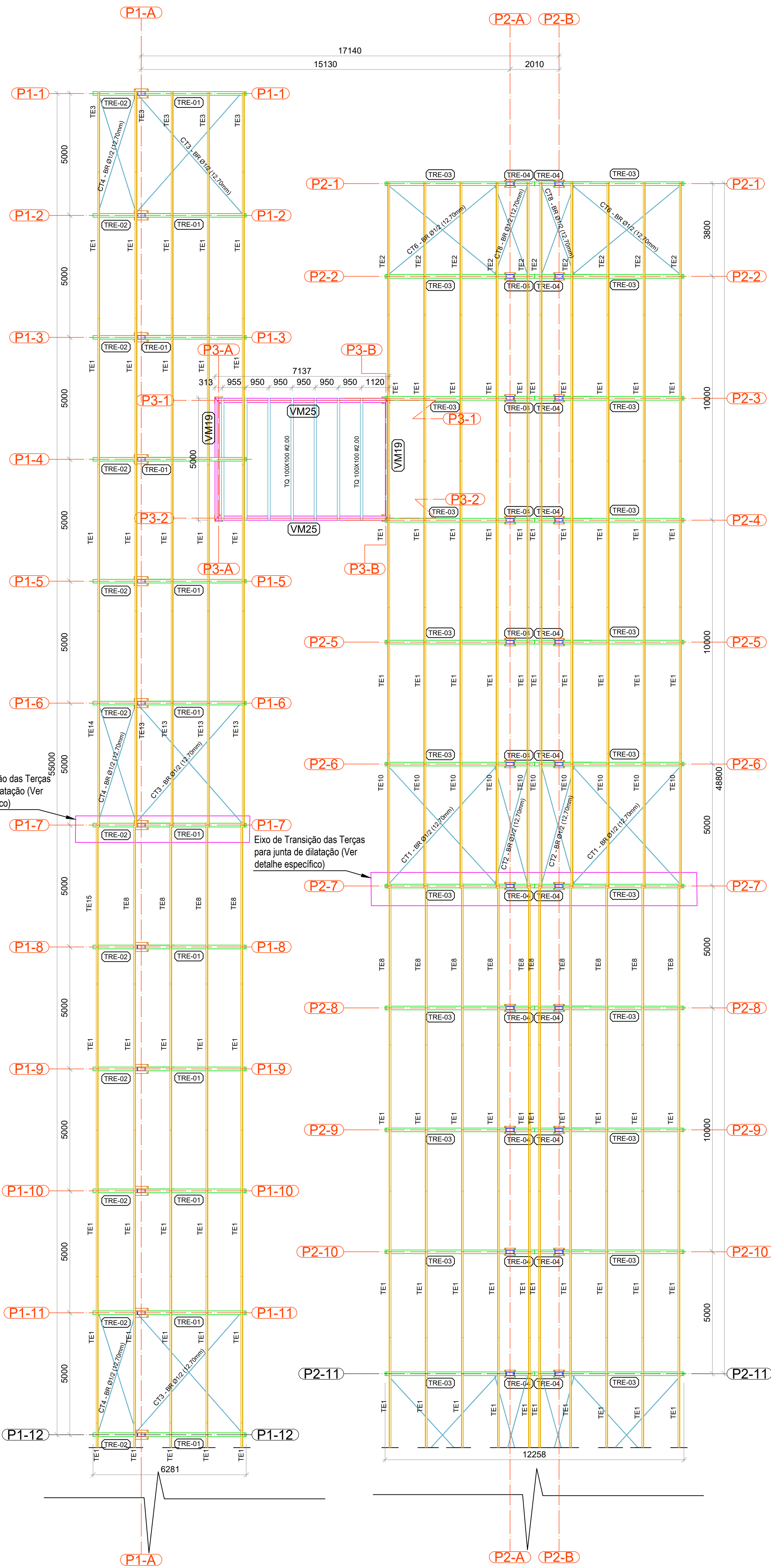
Planta de Montagem da Região 01 Estrutura metálica Esc: 1:100
